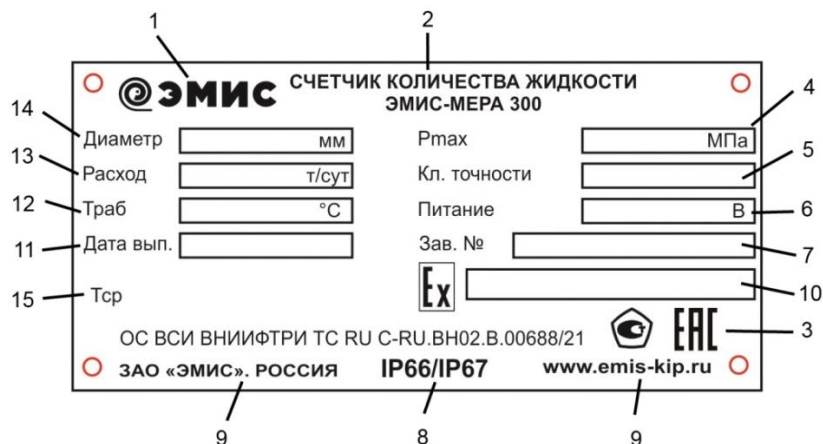
Рисунок 1.4 – Основная табличка счетчика
